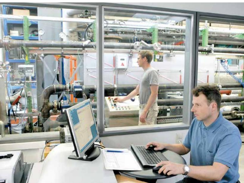
为确保测量和控制系统的精度，混合气体的组分，压力，温度，以及客户工厂负载条件带来的影响都会被精确的模拟。
