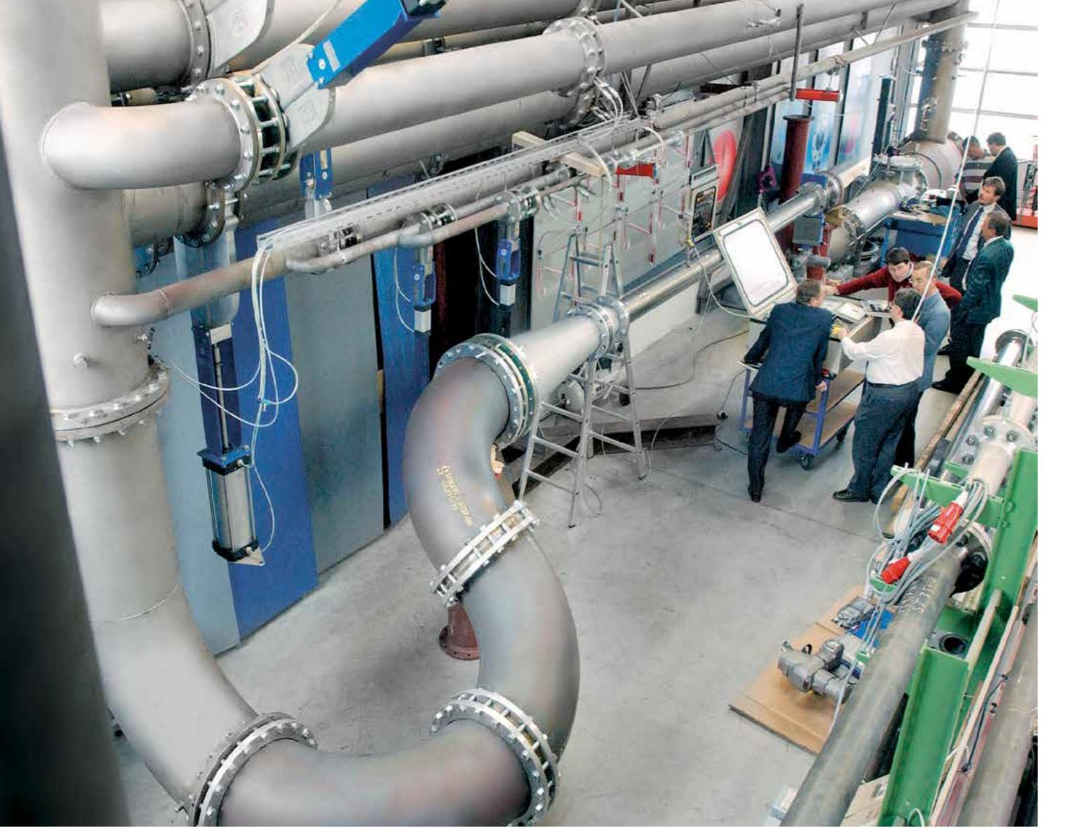
在CAMASS®系统模拟和校验实验中心对维也纳市政污水处理厂的VACOMASS®曝气精确分配与控制系统进行校准和正式验收。由于校准时，精确模拟了现场工况和管道布置，因而即使在复杂度较高的布管条件下，VACOMASS®系统整体流量控制精度得到了充分的保障，测控精度达到了流量读数的1.5%。
