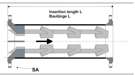
Flanschversion lang mit Vorschweißflansch (alternativ mit Bördel und Überwurfflansch) Gesamtlänge: 7\*D
