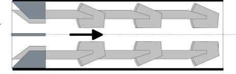
Flanschversion kurz mit Vorschweißflansch (alternativ mit Bördel und Überwurfflansch), Einbau der Gasmengenmessung 3\*D nach dem Gleichrichter
